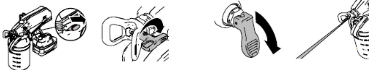
8. Uvolněte blokování spouště, otočte trysku do polohy k čištění a stiskněte blokování spouště po dobu cca 5 sekund, abyste stříkací přístroj odvzdušnili.
