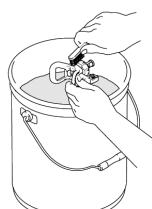
11. Rimuovere il serbatoio delle sostanze e smaltire il liquido detergente nel rispetto dell'ambiente.
