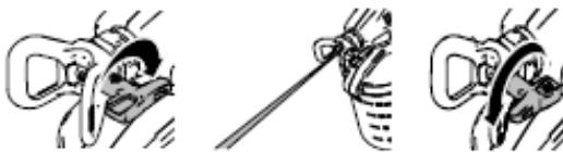
3. Uvolněte blokování spouště a stiskněte na cca 10 sekund spínač Zap / Vyp, abyste odvzdušnili čerpadlo. Pusťte potom spoušť a dejte odvzdušňovací / odlehčovací ventil dolů do polohy stříkání.
