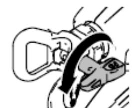
7. Una volta eliminato l'intasamento, azionare il blocco grilletto e riportare l'ugello nuovamente nella posizione di spruzzo.
