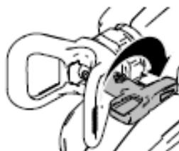
1. Abyste trysku uvolnili od ucpání, zablokujte blokování spouště a zatáhněte odlehčovací ventil do polohy nahoru, abyste odlehčili tlak.
