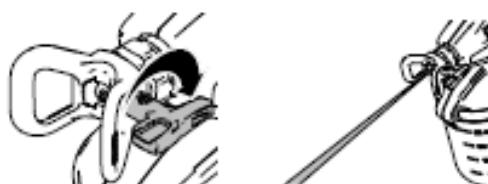
3. Posizionare in seguito la valvola di decompressione / di alleggerimento verso il basso nella posizione di spruzzo (DOWN).
