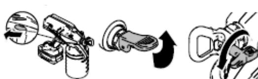
3. Puntare lo spruzzatore verso un serbatoio vuoto, togliere il blocco grilletto e portare la valvola di decompressione / di alleggerimento verso il basso nella posizione di spruzzo. Azionare il grilletto per eliminare l'otturamento.
