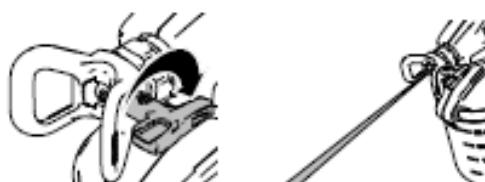
3. Dejte potom odvzdušňovací / odlehčovací ventil směrem dolů do polohy stříkání (DOWN).
