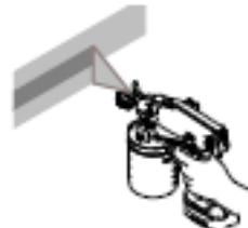
Zatáhněte za spoušť po začátku pohybu. Povolte spoušť před koncem pohybu. Stříkačí přístroj musí být v pohybu, když taháte za spoušť nebo ji povolujete.
