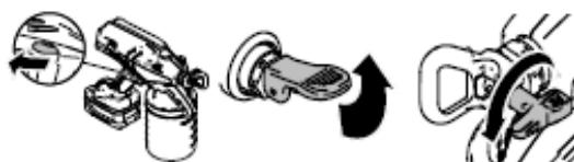
3. Nasměrujte stříkací přístroj do prázdné nádoby, odblokuje blokování spouště a přepněte odvzdušňovací / odlehčovací ventil dolů do polohy stříkání. Stiskněte spoušť, abyste odstranili ucpání.
