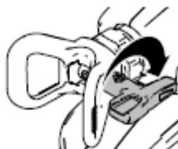
1. Per eliminare l'intasamento dall'ugello, azionare il blocco grilletto e portare la valvola di alleggerimento nella posizione UP, per alleggerire la pressione.
