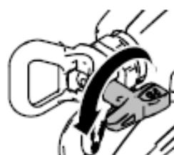
7. Pokud bylo ucpání odstraněno, zablokujte blokování spouště a otočte trysku zpět do polohy stříkání.
