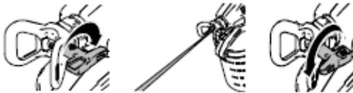
3. Togliere il blocco grilletto e azionare per ca. 10 secondi l'interruttore On / Off per spurgare la pompa. Rilasciare il grilletto e portare la valvola di decompressione / di alleggerimento verso il basso nella posizione di spruzzo.
